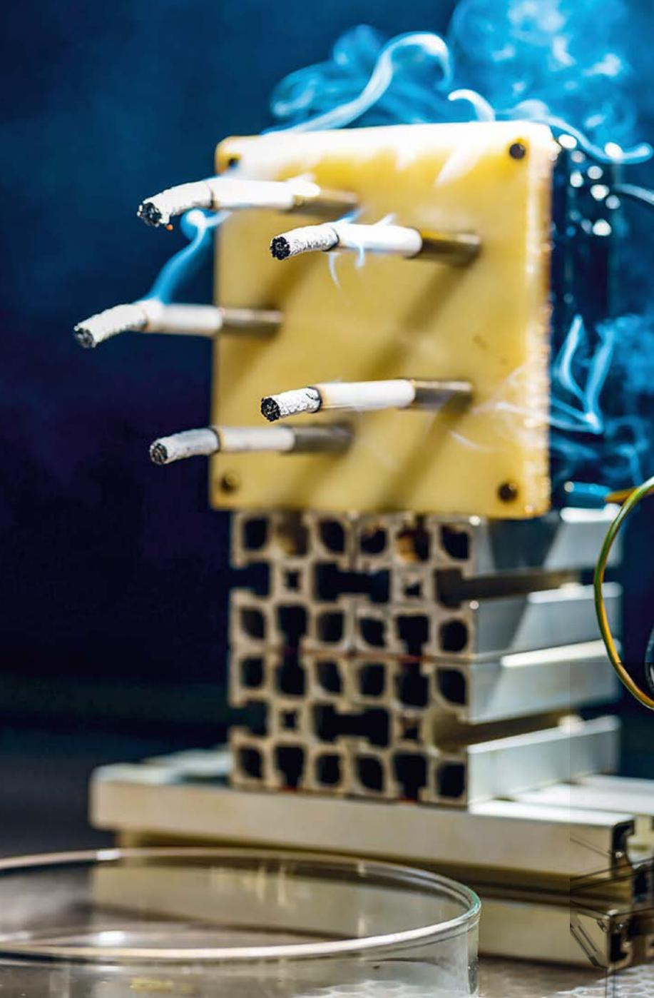
Ein Labor benutzt Zigaretten, um Luftfilter zu testen (links oben). Diese Systeme sollen nämlich Luft reinigen. Sind Koffer nach 30 Kilometern Testfahrt (rechts) noch ganz? Und beim Kopfhörertest (unten links) interessiert: Würde jemand in der Nähe die Musik hören? Sie soll nämlich niemanden stören.
